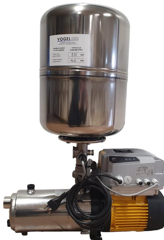
Der Elektro-Antriebsmotor, Schutzart IP 55, Isolationsklasse F, ist an eine MIDA-Regeleinheit (IP 66) angeschlossen, die einen Frequenzumrichter mit Mikroprozessor besitzt. Dieses System sichert einen konstanten Druck, egal wie hoch die verbrauchte Wasser-Fördermenge ist. Ein Schutz der Pumpe gegen **Trockenlauf** sowie gegen Überspannung ist ebenfalls möglich.
