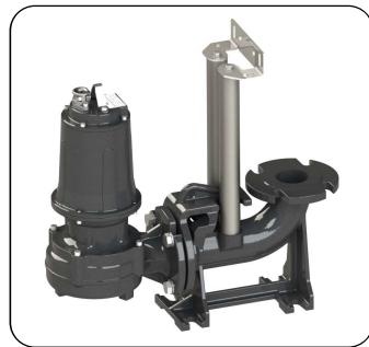
Cette solution s'avère avantageuse en cas d'installation fixe, car elle permet d'effectuer aisément et rapidement le retrait et le repositionnement successif de l'électropompe dans la cuve lors des opérations d'entretien et nettoyage de la pompe sans nécessité de vider la cuve de collecte ni de démonter aucun boulon.
