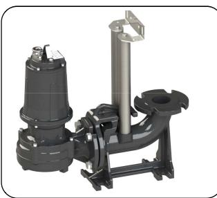
È questa la soluzione più conveniente nel caso di installazioni fisse perché consente di effettuare facilmente e velocemente l'estrazione e il successivo riposizionamento dell'elettropompa nella vasca, permettendo di eseguire la manutenzione e la pulizia della elettropompa senza dover svuotare la vasca di raccolta o smontare alcun bullone.
