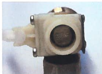
Siebeinsatz im Zulauf des Ventils eingesetzt
