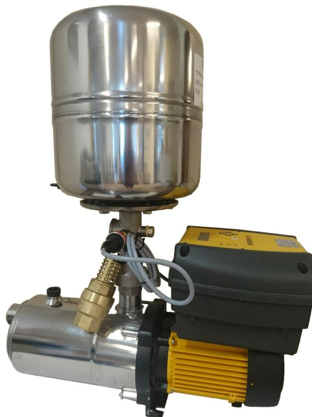
Der Elektro-Antriebsmotor, Schutzart IP 55, Isolationsklasse F, ist an eine SPEEDRIVE-Regeleinheit (IP 54) angeschlossen, die einen Frequenzumrichter mit Mikroprozessor besitzt. Dieses System sichert einen konstanten Druck, egal wie hoch die verbrauchte Wasser-Fördermenge ist. Ein Schutz der Pumpe gegen **Trockenlauf** sowie gegen Überspannung ist ebenfalls möglich.
